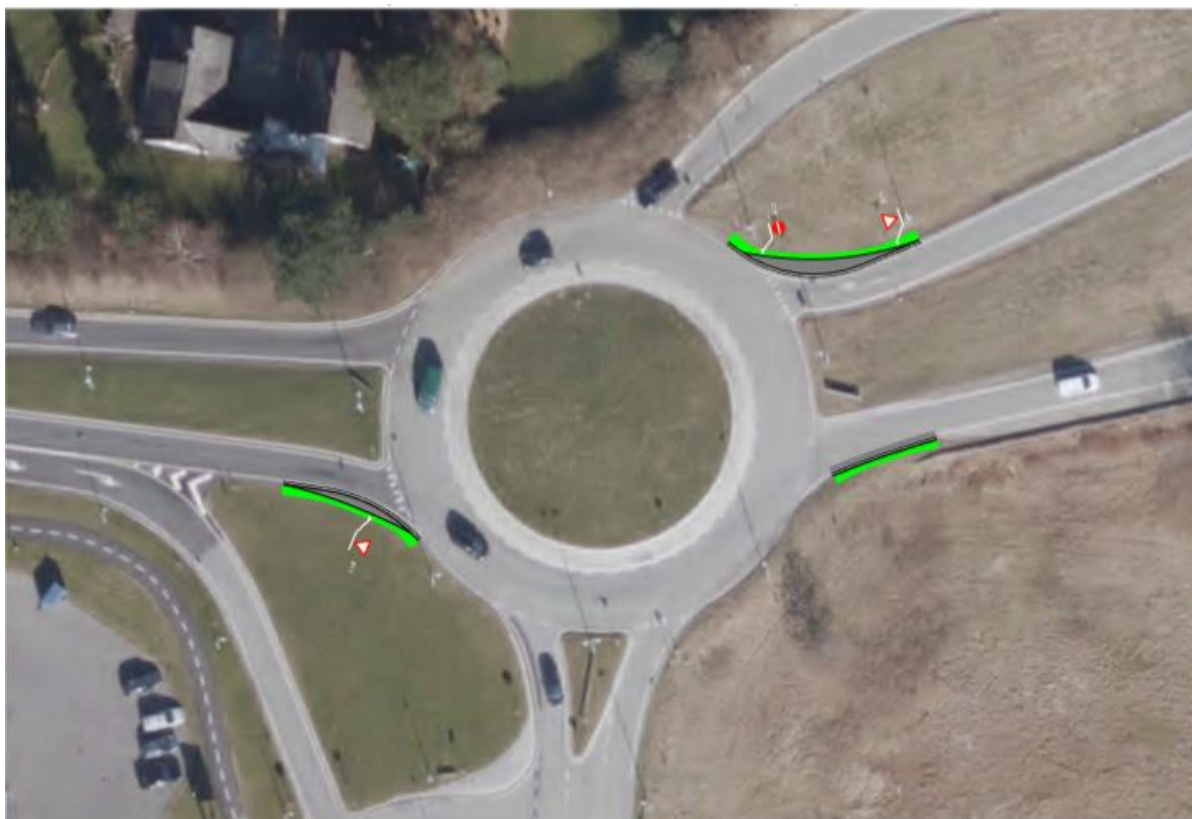
Figur 5-2: Forslag til sideudvidelser i rundkørsel – Isterødvejen/TSA 9
