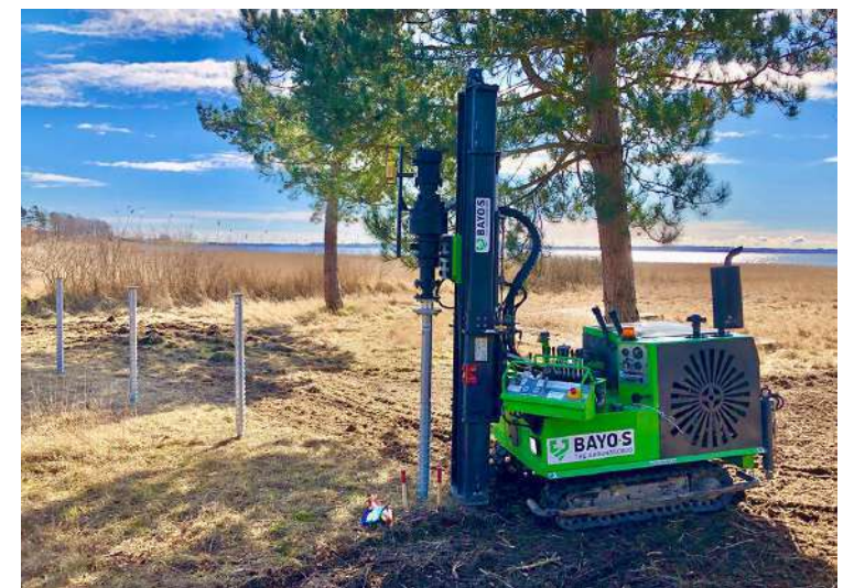
Eksempel på borerig på larvefodder til skruefundering i naturområder
