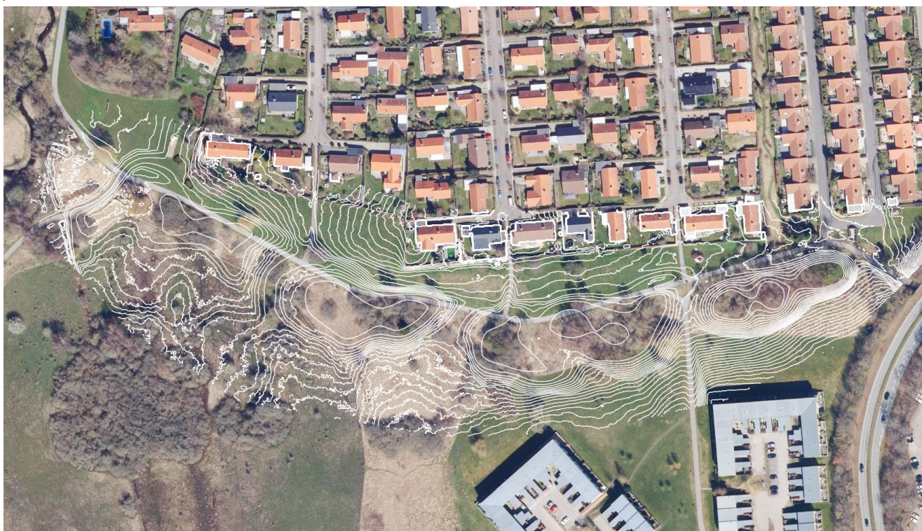
Figur 2.1 Terrasserne der udgør overrislingsarealerne, med hævnning af terrænet imellem. Længst mod øst er forbassinet med permanent vådvolumen.
